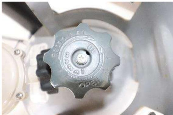
①プロパンガスのボンベバルブをOpenにする
