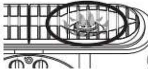
3. 点火しにくい場合は、器具栓ツマミを右 (OFF) の方向に回してガスを止め、しばらくたった後、再度1の方法で点火してください。
